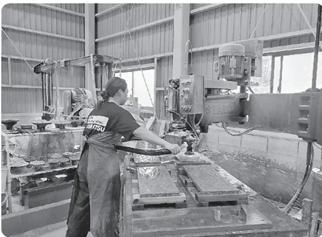
敷石の研磨加工中
